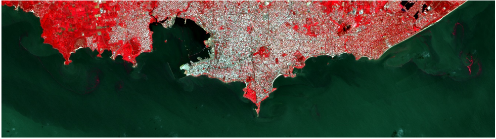
Figura 9.79: Detección de algas, composición Falso Color NIR,R,G.
