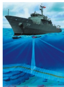
Figura 4.48: Levantamiento batimétrico (cortesía www.shoa.cl ).
