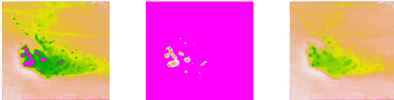
Figura 4.52: MDR batimétrico (izquierda), topografía (centro) y MDR producto de función 'cover()' con los valores NA en magenta.
