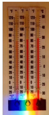
Figura 8.82: Termómetros midiendo temperaturas de diferentes colores según experimento realizado por Herschel. i-ciencias 9/ene/2016.
